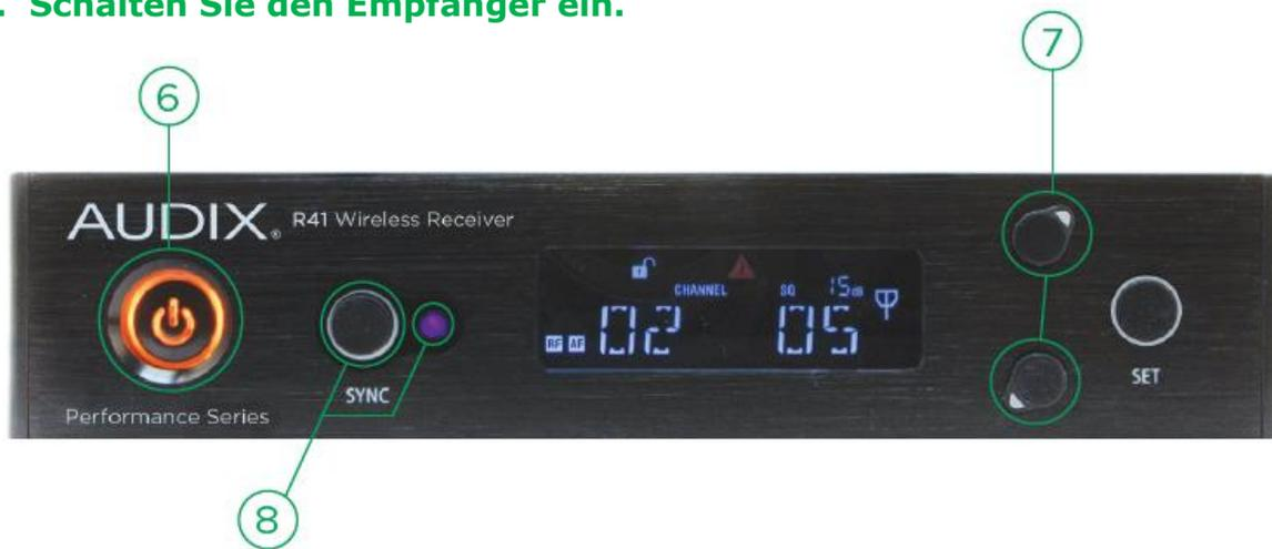
**7. Halten Sie den UP oder DOWN Taster eine Weile gedrückt**, um die Scanfunktion nach einer freien Gruppe/Kanälen suchen zu lassen. Nach 8-20 Sekunden wird eine freie Gruppe/Kanal auf dem Display dargestellt.
